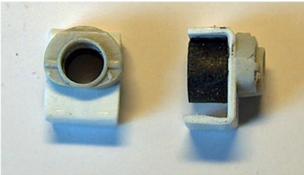
Ein 1,0 mm dicker und 10,0 mm breiter Styrene Streifen wurde auf einer Länge von 10,0 mm 2x um 90° umgebogen (Biegestelle mit einem Heißluft Föhn erwärmen). Aus einem Doppel Lampen Bauteil (USA-Trains Ersatzteil) durch halbieren zwei Frontlampenteile herstellen und ankleben. Die  $\varnothing 8,0 \times \varnothing 4,5 \times 5,0$  mm Rondelle ankleben.
