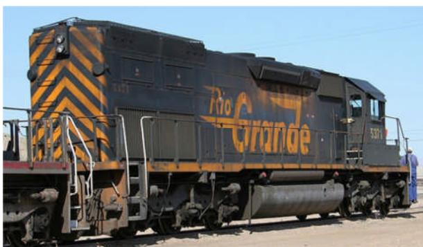
Die D&RGW RR beschaffte keine EMD SD40-2 sondern nur die augenfällige Variante SD40T-2. Das T steht für Tunnel. Damit die Motoren dieser Maschinen in Tunnels noch genügend Frischluft bekommen, saugen sie die Luft nicht im Dachbereich ein, sondern seitlich hinten und unten. Aus diesem Grund baute ich die Normale EMD SD40-2 in eine EMD SD40T-2 um. Bezeichnet werden diese Maschinen als **Tunnelmotors**.
